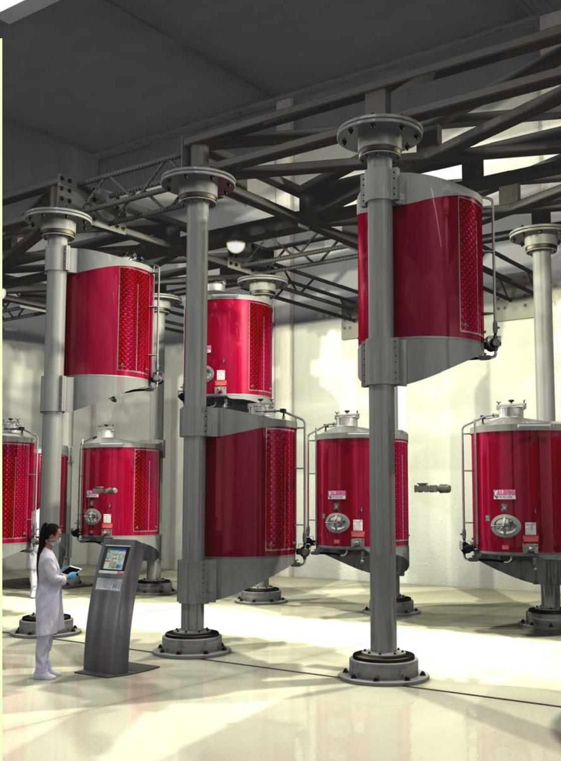
La présente invention a pour objet une cuve équipée de moyens de support innovants susceptibles de faciliter la gestion des différentes phases du processus de vinification, du stockage des liquides jusqu'à l'obtention du vin.
