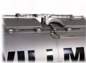
2 portes pneumatiques de 390 x 500 mm, commande tandem
