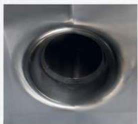
Soudure din interne du manchon, rasée et polie miroir
