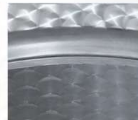
Soudure TIG satinée du bord de l'interstice
