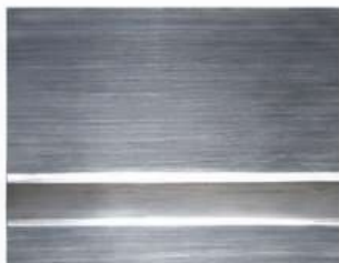
Soudure interne de porte, rasée et polie miroir
