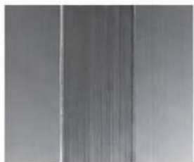
Soudure TIG/plasma interne roulée et polie miroir sur tôle polie miroir finition 2R rugo- sité de 0,06 Micron
