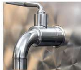
Soudure TIG brossée d'un manchon du dégustateur
