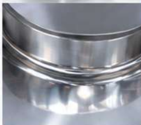
Soudure interne rasée et polie de la porte ronde
