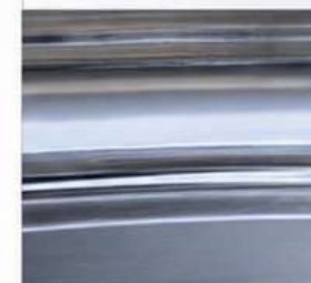
Soudure TIG/plasma circulaire interne du bord du fond roulée et polie miroir
