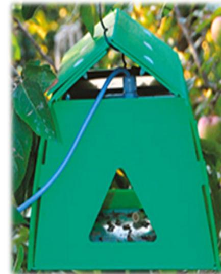
C'est un système basé sur Internet, qui prend automatiquement des photos en haute qualité de l'intérieur du piège et envoie les photos par GSM à un serveur internet pour effectuer des analyses. Il est possible d'utiliser tout les phéromones les plus courants avec le piège, par conséquent l'appareil peut être utilisé pour toutes sortes d'insectes. Ceci per-
